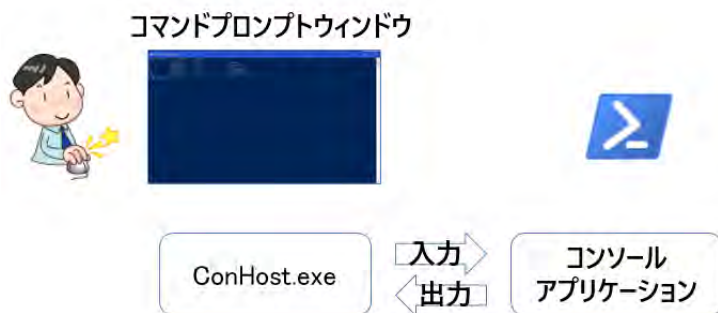
図 2.1 コンソールアプリケーションは Win32 に存在するコマンドプロンプトウィンドウ (ConHost) を通じて入出力を行う
